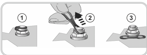
Şekil 3: Havalandırma Tapasının Devreye Sokulması
