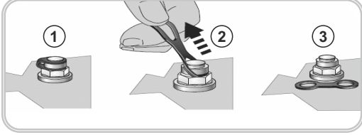
Şekil 3: Havalandırma Tapasının Devreye Sokulması
