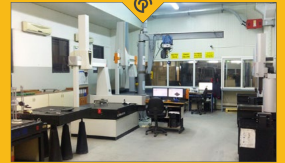
Kalite ölçüm ve kontrol laboratuvarı(5 tane CMM ölçüm cihazımız bulunmaktadır)
