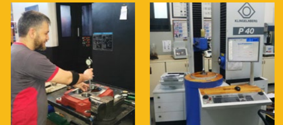
Ölçüm sonucu ve tezgah başında operatörün ölçüm alması
